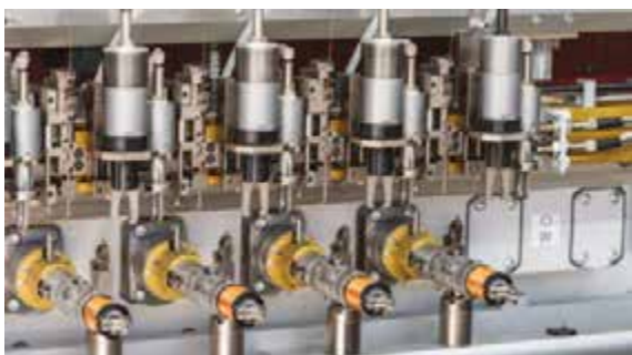
Processo di avvolgimento stratificato delle bobine con tensionamento elettronico dei tendifilo.
