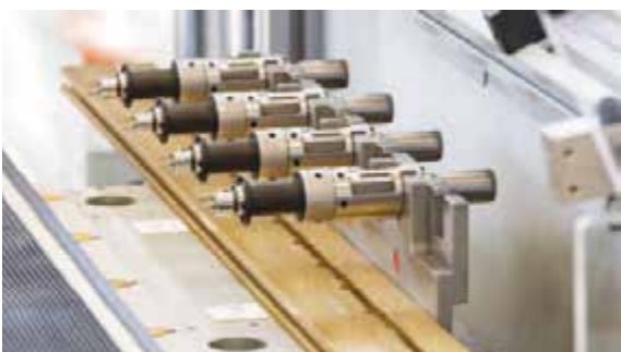
Dettaglio shuttle con postazione a quattro mandrini per asservimento avvolgitrice.
